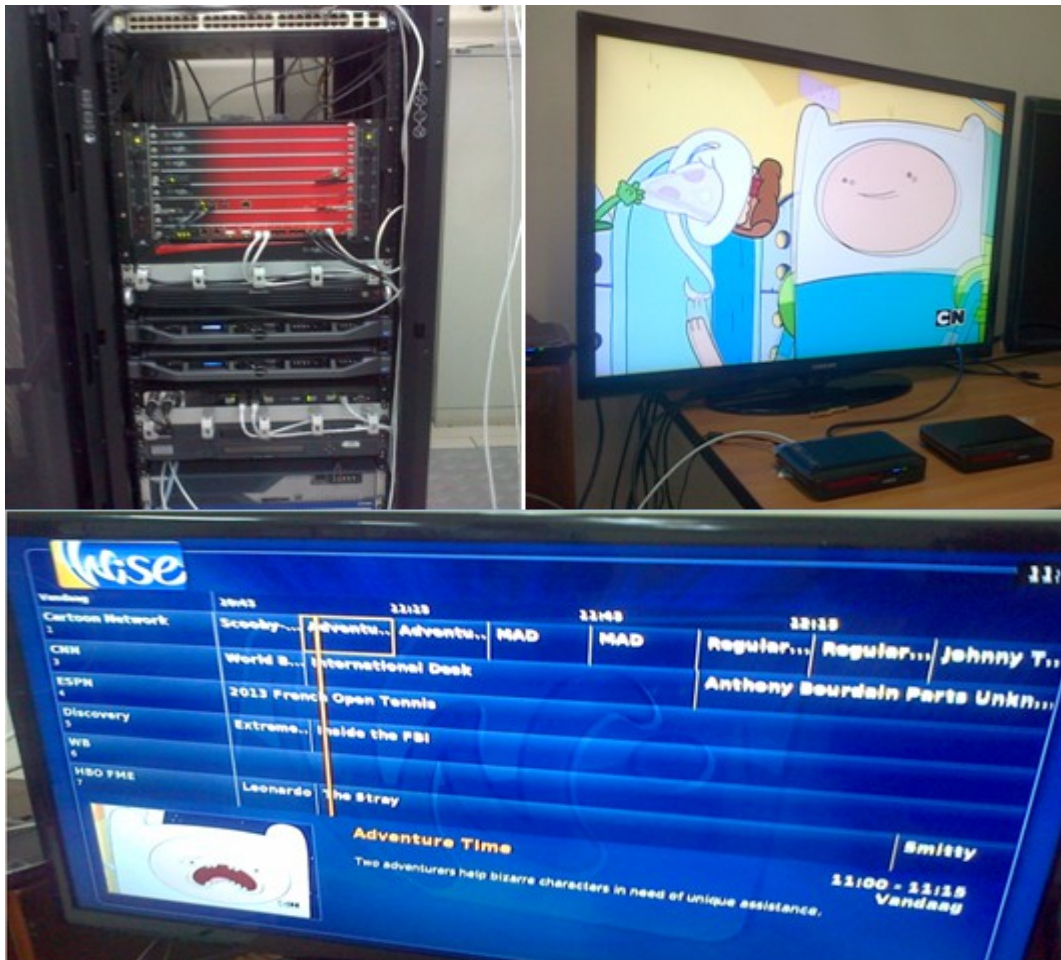
Figuur 18 IPTV- testopstellingen
