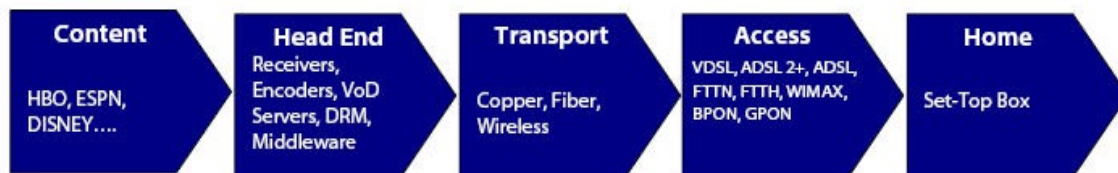
Figuur 8 Blokschema van IPTV dataverkeer
